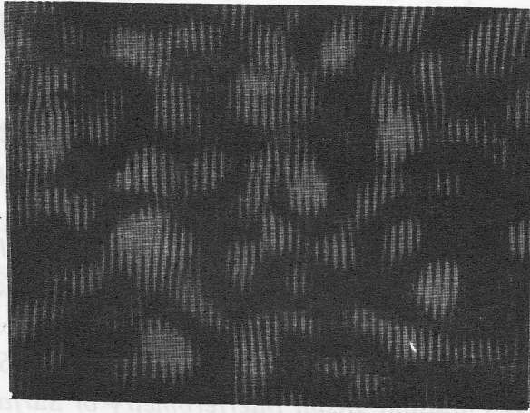
شكل رقم (١٤/٤) : التركيب الشبكي المتكون باستخدام طريقة تداخل البقعيات
