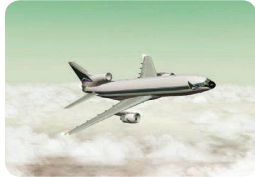
شكل (١٠): تعمل المركبة الأفقية لقوة رفع الطائرة كقوة جاذبة مركزية
