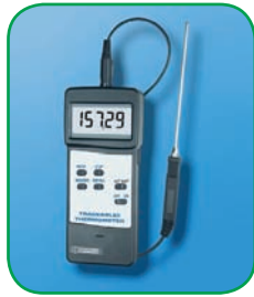
شكل (١٠): تتغير المقاومة الكهربائية بتغير درجة الحرارة في الترمومتر البلازمي
