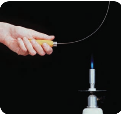
شكل (٣١): عند تسخين شريطين من معدنين مختلفين ملحومين مع بعضهما، فإنهما ينحنيان ناحية المعدن ذي معامل التمدد الأقل.
