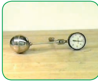
شكل (٩): يتغير الضغط بتغير درجة الحرارة في الترمومتر الغازي
