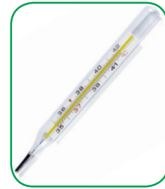
شكل (٨): يتغير الطول بتغير درجة الحرارة في الترمومتر السائل
