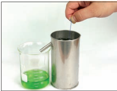
شكل (١٠): قياس الكثافة باستخدام الميزان والمخبر المدرج ينتج عنه خطأين في القياس.
