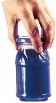
شكل (٣٣): الاستفادة من التمدد في فتح الغطاء محكم الغلق.
