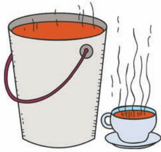
شكل (٦): رغم تساوى درجة حرارة الدلو والفنجان إلا أنهما لا يحتويان نفس الكمية من الطاقة.
