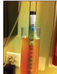
شكل (٩): قياس الكثافة بطريقة مباشرة باستخدام الهيدروميتر ينتج عنه خطأ واحد في القياس.
