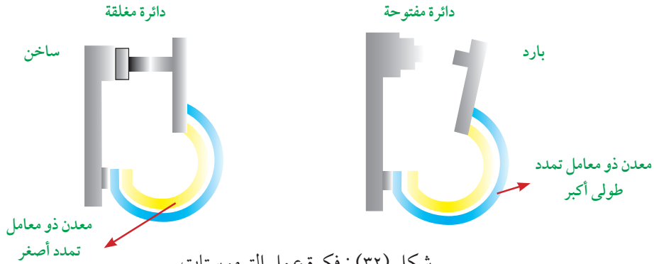
شكل (٣٢): فكرة عمل الترموستات
