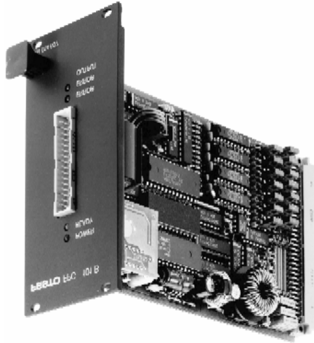
الشكل ٣ - ٢٠ لوحة التحكم المنطقي المبرمج PLC
