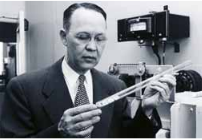
٨ ابتكر الكيميائي كالفن فولر Calvin Fuller خلية ضوئية عندما سخن البورون والسيليكون (هنا، في أنبوب).
