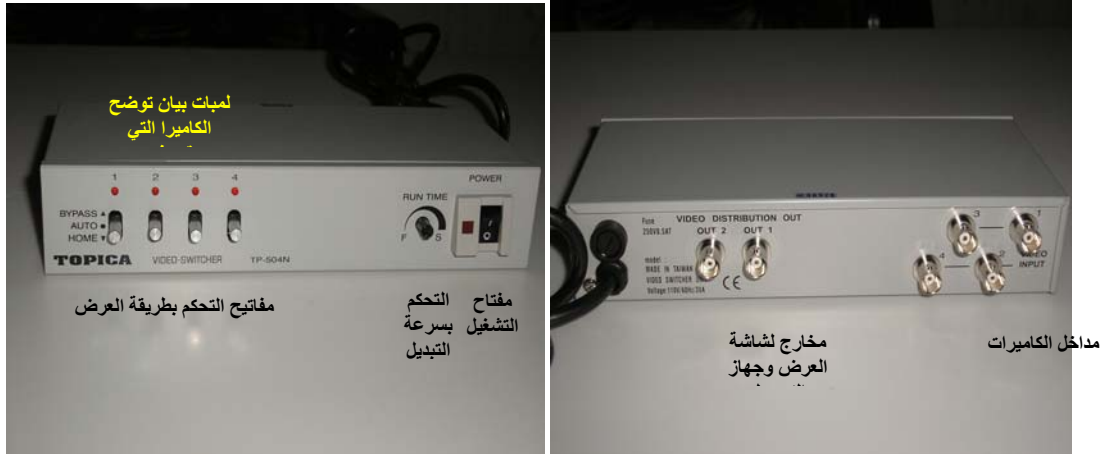
الشكل (10 - 2): جهاز التحكم والتبديل بين الكاميرات
