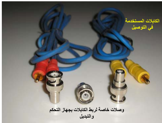
الشكل (11 - 2): الأسلاك المستخدمة في التوصيل مع وصلات خاصة بجهاز التحكم
