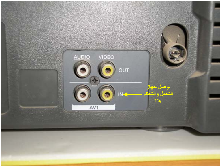
الشكل (14 - 2): لوحة التوصيل لشاشة العرض
