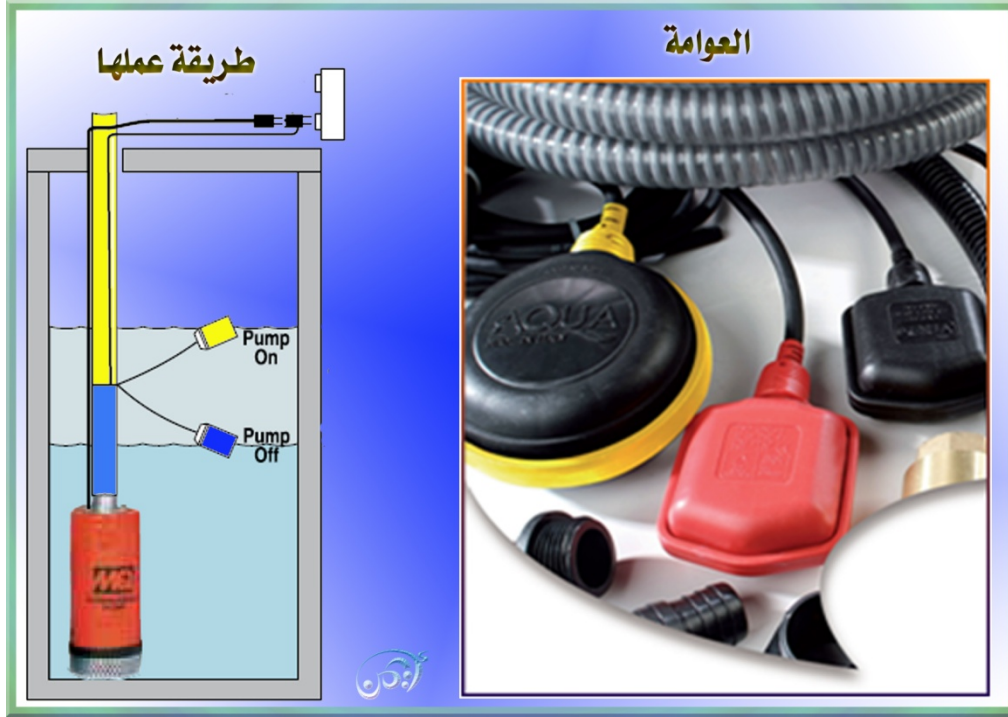
شكل رقم ( 4 - 12 ) يوضح العوامة وطريقة عملها
