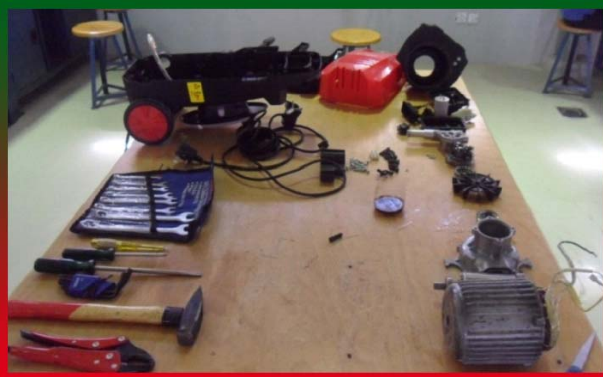
ملاحظة : خطوات التجميع تتم عكس خطوات الفك
