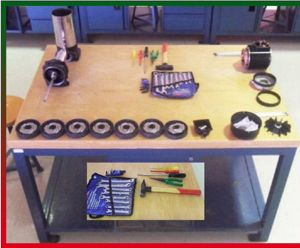
شكل مجمع للمضخة بعد عملية الفك
