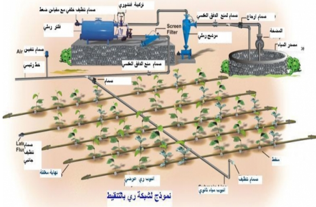
شكل ( 5 - 2 ) يوضح نموذج لشبكة ري بالتنقيط
