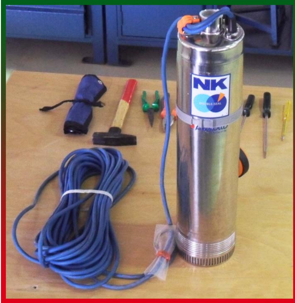
شكل ( 5 - 17 ) يوضح تركيب المضخة الغاطسة للأعماق البعيدة
