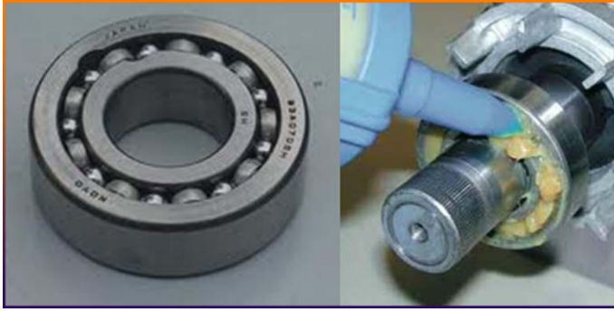
شكل رقم ( 4 - 6 ) يوضح رولمان البلي وطريقة وضع الشحم عليه
