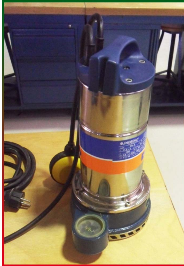
شكل ( 5 - 18 ) يوضح شكل مضخة غاطسة للأعماق الضحلة
