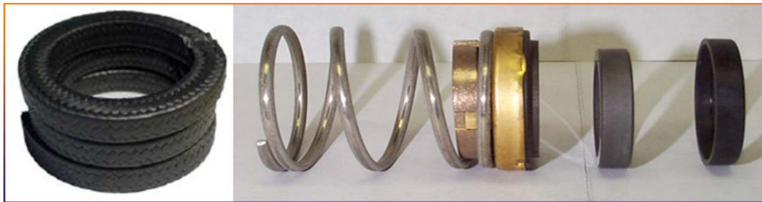
شكل رقم ( 4 - 7 ) يوضح أشكال موانع التسرب
