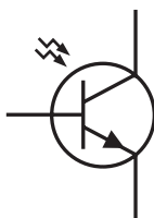
رمز الترانزستور الضوئي ذي الثلاثة أطراف
