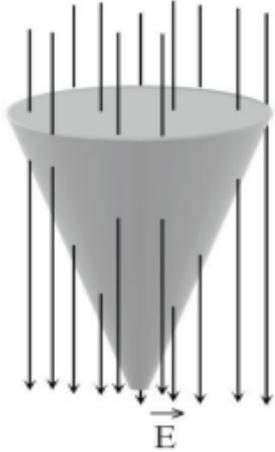
مثال ١ : في الشكل مخروط قطر قاعدته 0.4 m وارتفاعه 2 m يجتازه عموديا على قاعدته مجال كهربائيا منتظما مقداره 5000N/C كما في الشكل ما مقدار التدفق الذي يجتاز السطح المخروطي فقط وماذا يصبح هذا التدفق عندما يصبح المجال أفقي نحو x الموجب .
