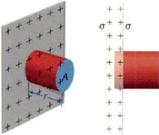
عندما يكون اللوح موصل مساحته لا نهائية كثافة شحنته السطحية  $\sigma$  موجبة على كل سطح لإيجاد المجال الكهربائي عند نقطة تبعد مسافة  $r$  عن السطح نختار سطحاً جاوسياً على شكل أسطوانة قائمة مساحة مقطعها العرضي  $A$  وطولها  $2r$  تقطع المستوى بشكل عمودي لكن في هذه الحال يحيط الموصل بأحد طرفي الأسطوانة وبما أن المجال
