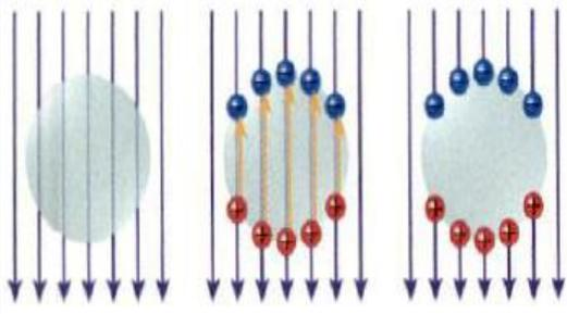
لنفترض وجود محصلة مجال كهربائي للحظة ما عند نقطة معينة داخل موصل معزول ، لكن يحتوي كل موصل على إلكترونات حرة داخله وهي تتحرك الى السطح الخارجي تاركة أيونات موجبة الشحنة وتنتج هذه الشحنات مجالا كهربائيا داخل الموصل يعاكس
