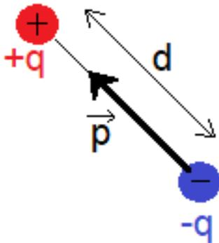
نعرف كمية متجهة باسم عزم ثنائي القطب الكهربائي P يكون اتجاه عزم ثنائي القطب هذا من الشحنة السالبة إلى الشحنة الموجبة وهو عكس اتجاه خطوط المجال الكهربائي ونحصل على المقدار p لعزم
