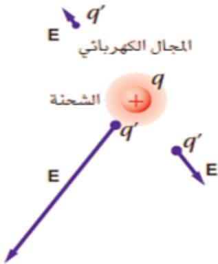
**E** : شدة المجال الكهربائي عند النقطة ( N/C )
