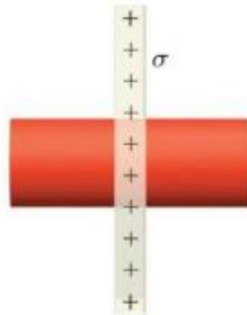
لدينا لوح مسطح رقيقاً وغير موصل مساحته لا نهائية ويحمل شحنة موجبة كثافة شحنته السطحية  $\sigma$  لإيجاد المجال الكهربائي عند نقطة تبعد مسافة  $r$  عن السطح نختار سطحاً جاوسياً على شكل أسطوانة قائمة مغلقة مساحة مقطعها العرضي  $A$  وطولها  $2r$  تقطع المستوى بشكل عمودي .
