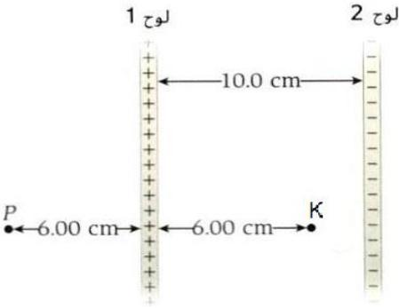
٣- يبعد لوحا شحنة لا نهائيان عن بعضهما مسافة 10 cm كما في الشكل وتوزيع الشحنة السطحي للوح 1 هو  $3\mu\text{C}/\text{m}^2$  وللوح الثاني  $-5\mu\text{C}/\text{m}^2$  أوجد المجال الكهربائي الكلي عند النقطة P على مسافة 6cm يسار اللوح 1 وعند النقطة K على مسافة 6cm يمين اللوح 1
