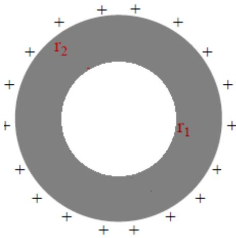
موصل كروي مجوف نصف قطره الداخلي  $r_1$  ونصف قطره الخارجي  $r_2$  مشحون بشحنة موجبة لإيجاد المجال أولا داخل الموصل نأخذ سطح جاوسي على شكل كرة نصف قطرها  $r < r_1$  بتطبيق قانون جاوس :
