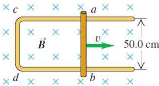
28- الشكل المجاور يبين موصل  $a, b$  ينزلق على سلكين دون احتكاك بسرعة ثابتة قدرها  $7.50\text{ m/s}$  عموديا على مجال مغناطيسي منتظم شدته  $0.8\text{ T}$  . ما مقدار القوة الدافعة المستحثة المتولدة بالسلك وما اتجاهها بالسلك
