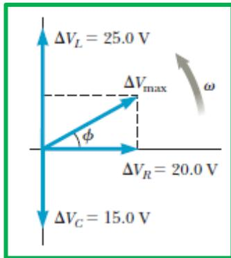
81- الشكل المجاور يبين المتجهات الطورية في دائرة (AC) و تركيبها RLC . فإذا كانت المقاومة تساوي  $75\Omega$  وتردد المصدر  $60.0Hz$  أوجد :
