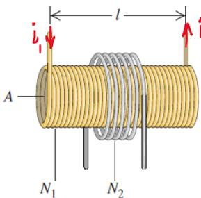
38- الشكل المجاور يبين ملف لولبي طويل طوله  $l = 0.5m$  وعدد لفاته ( لفة  $N_1 = 1000$  ) ومساحة مقطعه  $A = 10cm^2$  ويمر به تيار بمعدل ثابت و محاط بملف دائري عدد لفاته ( لفات  $N_2 = 10$  ) كما بالشكل المجاور، فإن معامل الحث المتبادل بين الملفين ( M ) يساوي
