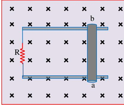
26- الشكل المجاور يبين موصل  $a, b$  طوله  $0.2\text{ m}$  ينزلق على سلكين دون احتكاك بسرعة ثابتة قدرها  $4\text{ m/s}$  عموديا على مجال مغناطيسي منتظم فتولدت فيه قوة دافعة كهربائية مستحثة مقدارها  $2.4\text{ V}$  بين طرفي السلك  $(a, b)$  حيث جهد الطرف  $(b)$  أعلى جهداً من الطرف  $(a)$  لذلك فإن
