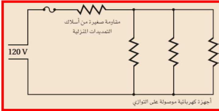
س ( وُصل مُجفّت شعر مقاومته  $12\Omega$  ومصباح كهربائي مقاومته  $125\Omega$  معًا على التوازي بمصدر جهد مقداره 120 v
