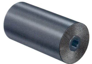
الشكل 4.4 يمكن لف الرقائق المعدنية وشطيرة المايلاز الموصّحة في الشكل 4.3 بطبقة عازلة لإنتاج مكثف ذي شكل هندسي مدمج.
