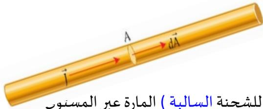
• **كثافة التيار J** : هي مقدار التيار بالنسبة إلى مساحة مقطع الموصل .
