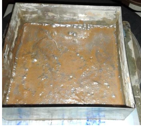
الشكل (3-3) القالب المصمم لصب العينات
