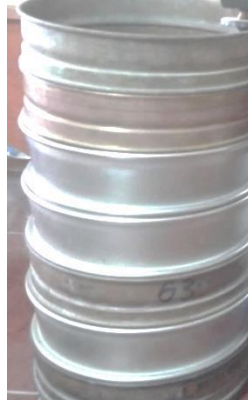
الشكل (4-13) المناخل المستخدمة في تحديد التوزيع الحجمي والحبي لجزيئات الإسمنت
