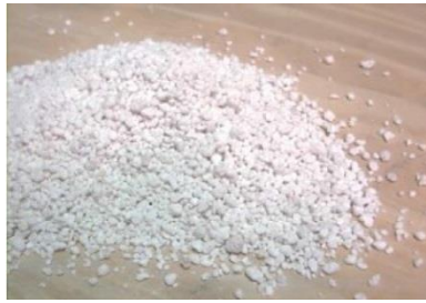
الشكل (1-9) حبيبات البيرلايت المستخدمة في العزل الحراري
