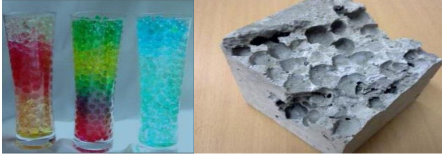
الشكل (32-1) الخرز البلوري المائي مع العينة الخرسانية الناتجة
