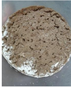
الشكل (2-3) الملاط بعد إضافة كربونات الأمونيوم إليه
