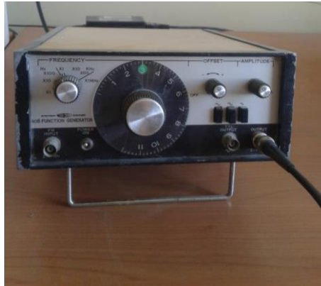
الشكل (4-7) جهاز التغذية الكهربائي الخاص باختبار معامل امتصاص الصوت
