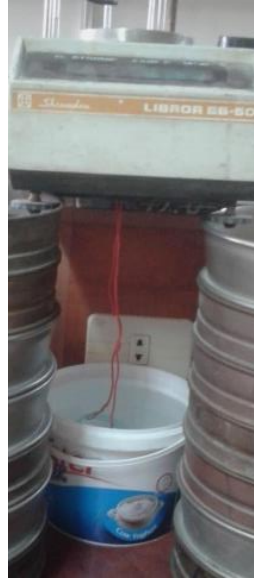
الشكل (5-3) قياس المسامية حيث علقت العينة بالشريط الأحمر المرتبط بذراع الميزان
