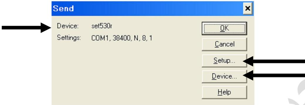
بعد اختيار الأمر Device يتم وضع المؤشر على نوع الجهاز ثم نضغط على OK وإن لم يكن النوع موجود في القائمة يتم إدخاله عن طريق الأمر New وتحت النوع Power SET Memory كذلك يتم الضغط على الأمر Setup لوضع إعدادات البرنامج متوافقة مع إعدادات الجهاز
