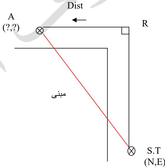
يتم اختيار نقطة مساعدة يمكن منها رؤية النقطة التي لا يمكن التوجيها عليها بالجهاز (لوجود عائق) ووجود النقطة المحتملة بالجهاز ثم يتم قياس المسافة Distance من النقطة المساعدة إلى النقطة التي خلف العائق بواسطة شريط أو أي أداة أخرى وتحديد الاتجاه Direction على شاشة الجهاز باختيار السهم المناسب للاتجاه
