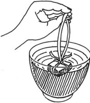
النتائج: الشريط المطاطي هو أطول بكثير عندما تكون الصخور معلقة في الهواء مما هو عليه عندما يكون في الماء. قوة تسمى الجاذبية تسحب الصخرة نحو الأرض ويسمى هذا السحب بوزن الصخرة، الدفع التصاعدي في الهواء يغير بعض الوزن ولكن الدفع التصاعدي في الماء يجعل التغير أكثر وضوحاً في وزن الصخرة.
