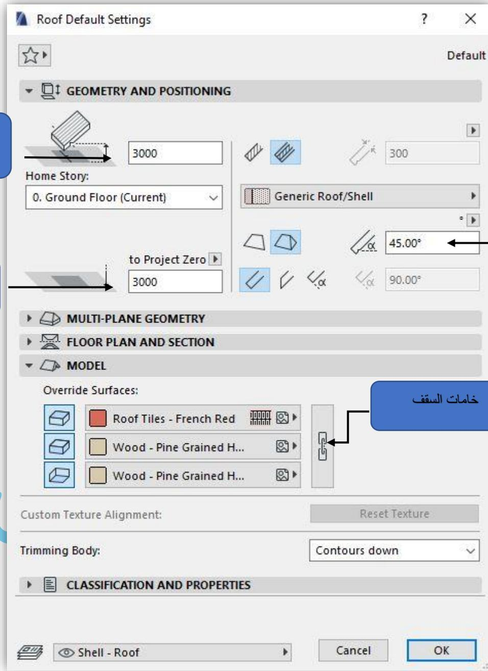
وبعد تحديد تعديلات التي نحتاجها نقوم باختيار مكان وضع السقف في مكانها المطلوب ثم نضغط (OK)
