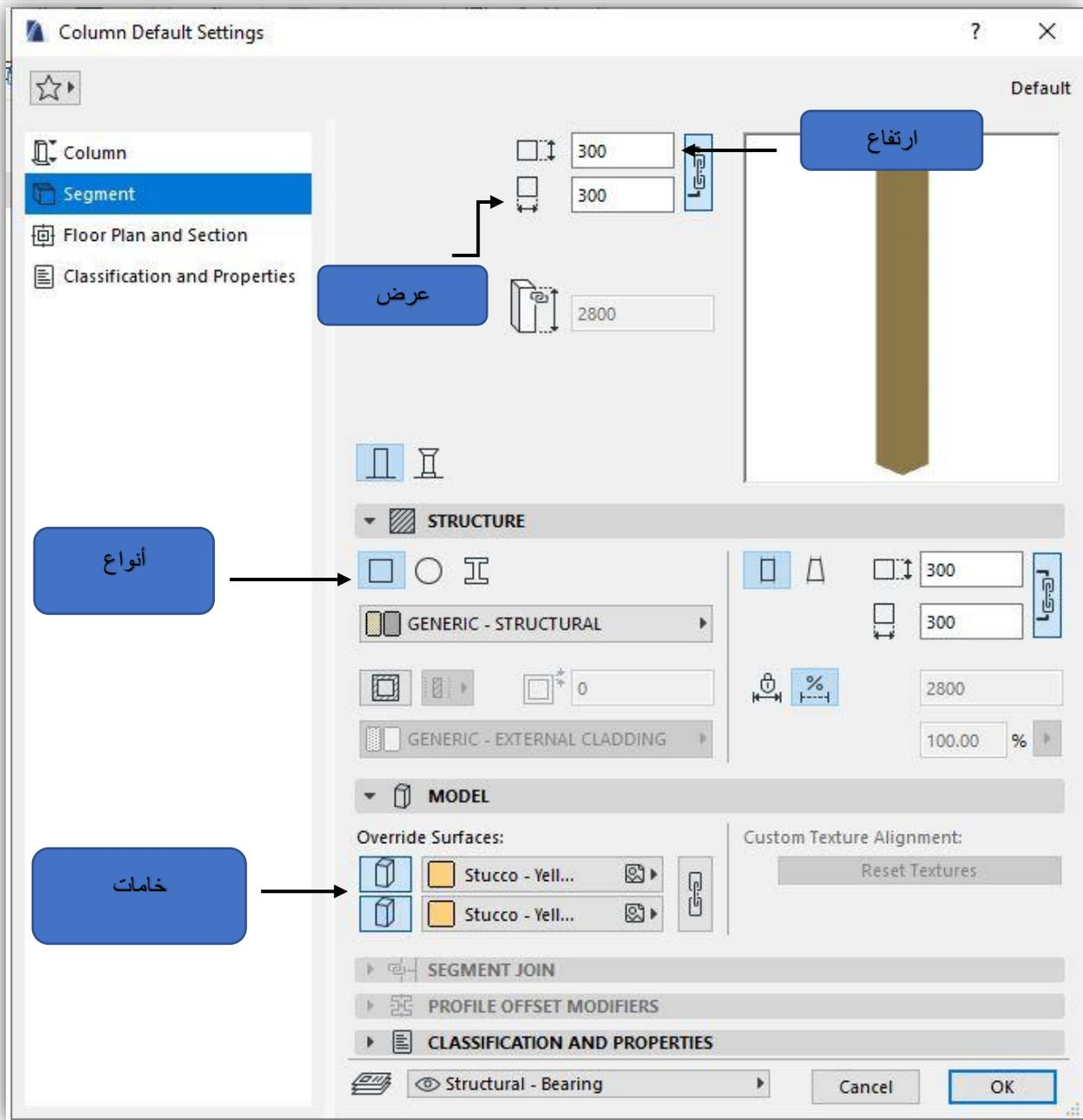
وبعد تحديد تعديلات التي نحتاجها نقوم باختيار مكان وضع (Column) في مكانها المطلوب ثم نضغط (OK)
