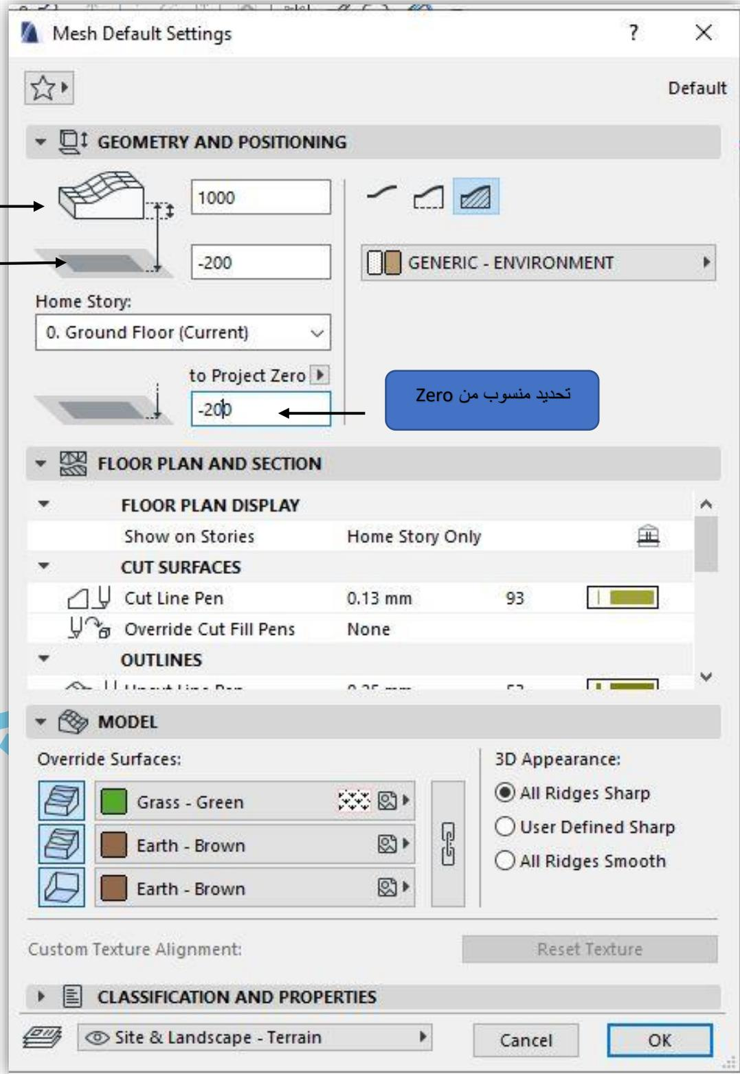
وبعد تحديد تعديلات التي نحتاجها نقوم باختيار مكان وضع (Mesh) في مكانها المطلوب ثم نضغط (OK)
