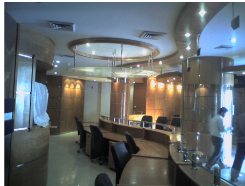
صورة توضح موزعات الهواء و جريلات السحب في كل من الممرات و مكاتب الموظفين، المصممة بطريقة مفتوحة على بعضها البعض، مما يزيد من كفاءة التكييف في الفراغات
