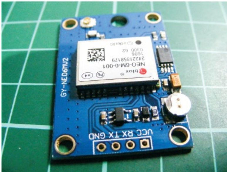
FIGURE 25-1: The Ublox NEO-6M GPS module
