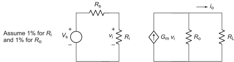
$$\frac{R_i}{R_i + R_s} \geq .99, \quad R_i (1 - 0.99) \geq 0.99 R_s$$
