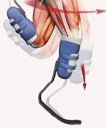
الشكل 2 عندما تصطدم القدم الاصطناعية بالأرض، فإنها تنضغط وتخزن الطاقة من أثر الاصطدام.
